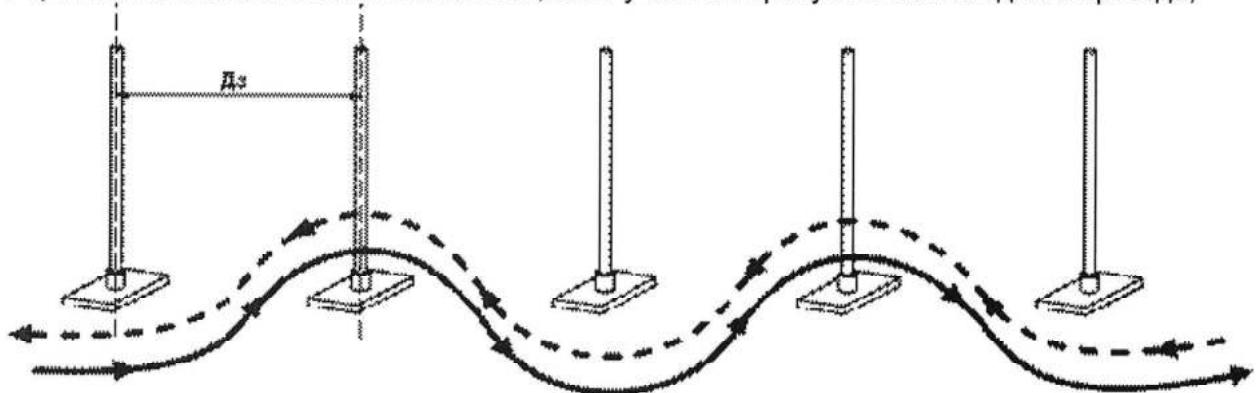
6) фигура "Колея" - две пары ограничителей в виде брусков, образующих проезд для колес одной стороны автобуса.
