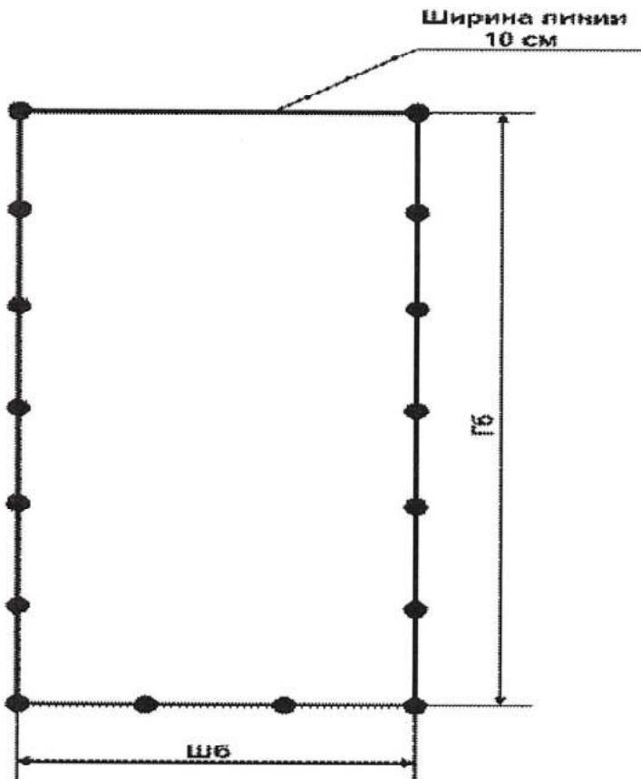
3) фигура "Стоянка" - прямоугольник, ограниченный стойками с трех сторон, с открытой стороной по длине автобуса, обозначенной на открытой поверхности площадки линией шириной 10 см.
