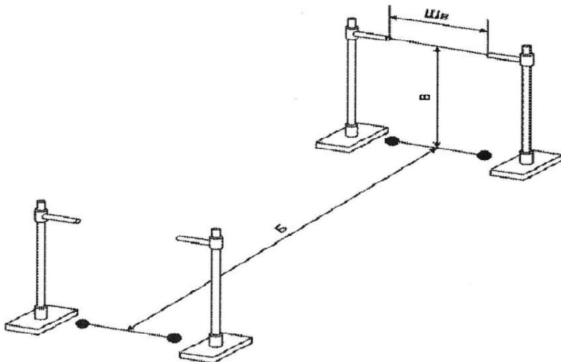
5) фигура "Змейка" - пять стоек, установленных по прямой линии с одинаковыми интервалами, образующими четыре проезда.
